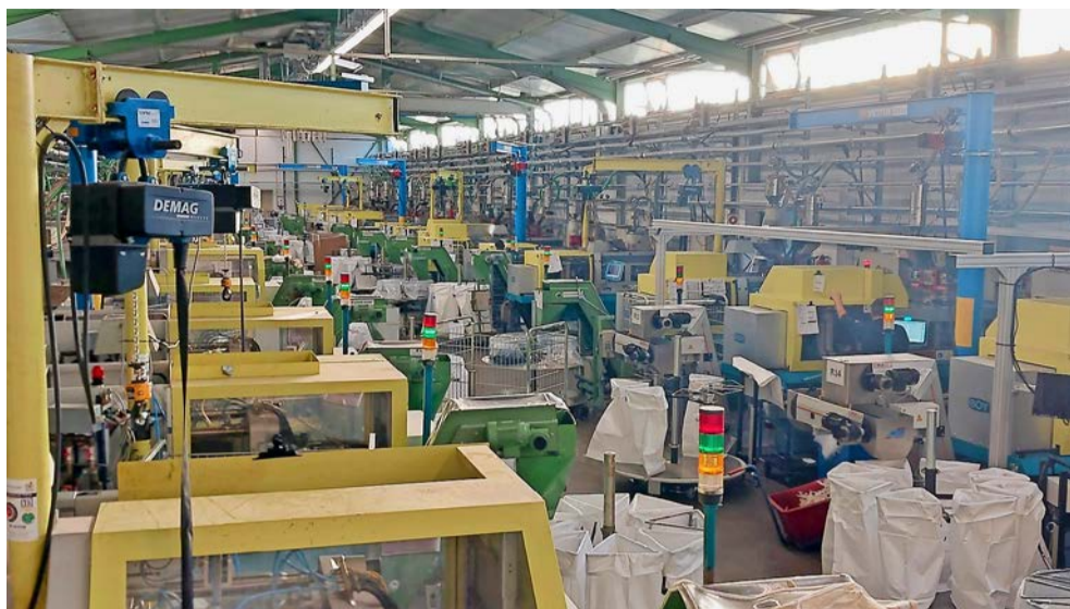
32 Spritzgießmaschinen hat Cena in der Fertigung stehen. Sie stammen ausschließlich von Boy. Die Hälfte der Maschinen nutzt Cena ausschließlich für die Verarbeitung von Polyolefinen. Auf der anderen Hälfte werden sowohl Polyolefine als auch technische Kunststoffe verarbeitet.
